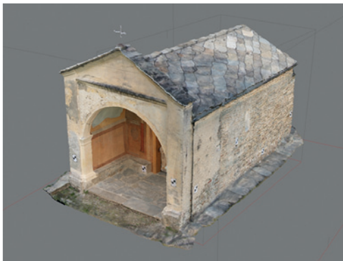
Fig. D2 - Mesh texturizzata delle superfici esterne dell'edificio derivata dalla nuvola di punti.
