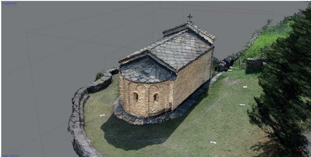
Fig. D1 - Nuvola di punti della Cappella di S. Eldrado con relativo contesto ambientale ottenuta da tecniche di Structure From Motion.
